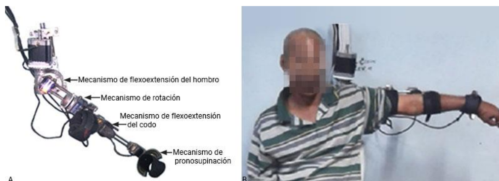
Fig 1- (a) Exoesqueleto para rehabilitación del miembro superior. (b) Paciente durante la ejecución de movimiento de abducción.
